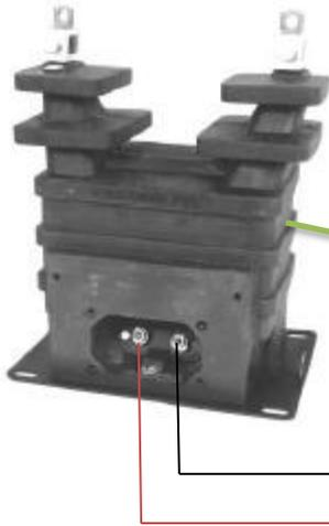
Para medir la resistencia de aislamiento entre contactos secundarios
